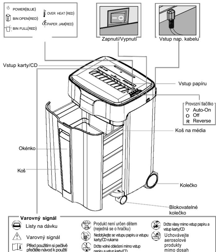
1. Nedotýkejte se odkrytých nožů pod hlavou skartovače.
